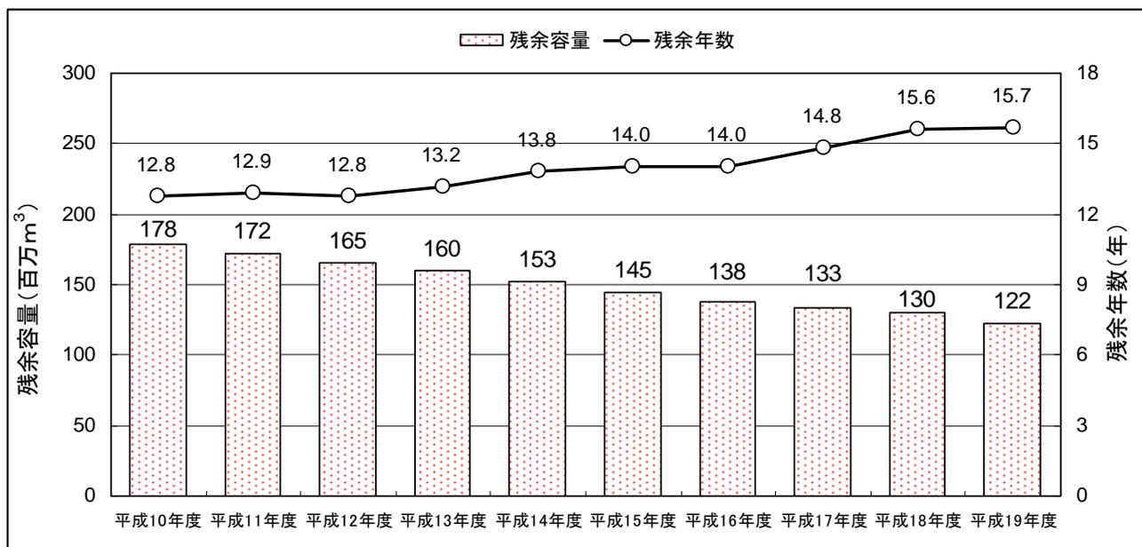
図-18 一般廃棄物最終処分場の残余容量と残余年数の推移<sup>(注14)</sup>
