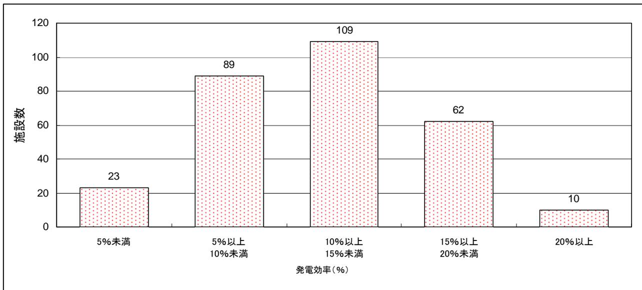
図－14 ごみ焼却施設の発電効率別の施設数<sup>（注12）</sup>
